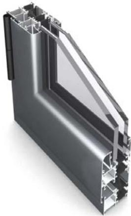
El **acristalamiento** estará realizado por vidrio aislante de control solar bajo emisivo, que consta de dos vidrios de seguridad de 3+3 mm de espesor y un vidrio de 6 mm, separados por una cámara de aire deshidratado, de 12 mm de espesor, que le confiere unas óptimas propiedades de aislamiento térmico y acústico.
